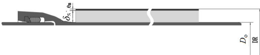
图1 直埋预制保温球墨铸铁管道尺寸示意图
